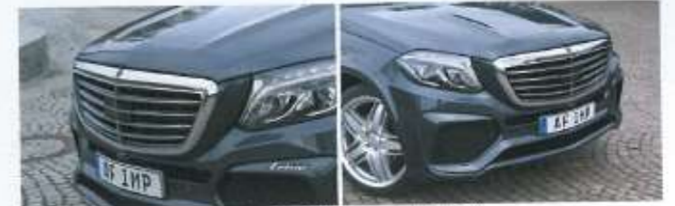
↑W222用グリルの移植で、顔だけ見ればSクラスに見える。ボンネットが延長され、押し出しは強まっているが、クラシカルなルーバーなので、エレガントさを感じさせる。
