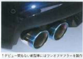
↑デビュー間もない新車車にはワンオフマフラーを製作することも多い。人気車種になりそうな場合は、ワンオフモデルをベースに美観マフラーを開発することもある。
