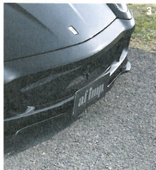
3.フロントスポイラーはバンパー下に装着するフラップスタイル。ノーマルバンパーの計算され尽くした空力を活かす設計だ 4.コンパクトながらGTマシンにも通じるシルエットを持つリアウイングも装着
